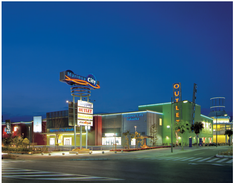
夜景外観 マリーナ通りから望むアウトレットⅢ棟の外観。看板やサインを目立たせて認識させる配慮から、街路灯の明かりは抑えた照明設計となる
