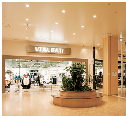
1階コーナー部 人の交流と溜まりの場となるコーナー部では、CDMダウンライトを数多く配して施設内の基点としての位置付けをしている
