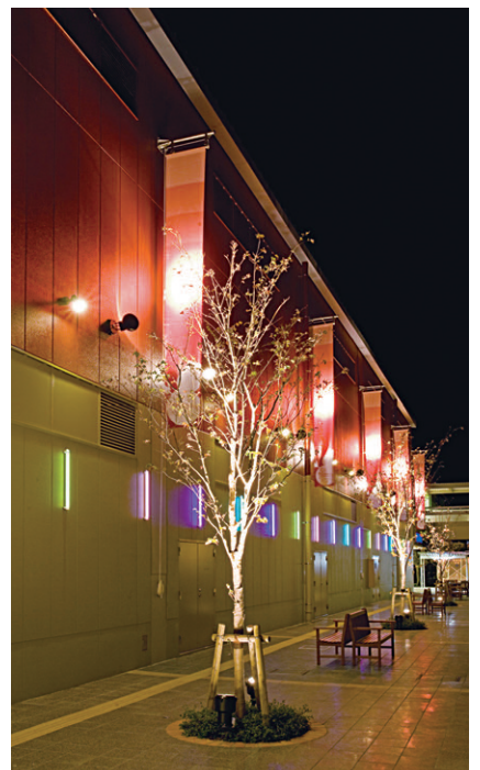
中庭スペース アウトレットⅡ棟とⅢ棟の間に設けられた中庭スペース。Ⅲ棟の壁面に取り付けたCDMランプスポットライトでショップカーテンに当てて光感を出す
